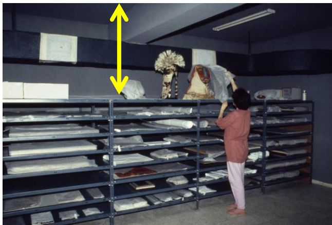
صافي الارتفاع أو المساحة الرأسية القابلة للاستخدام هو ليس بالضرورة ارتفاع الغرفة، وذلك لوجود عوائق مختلفة (في هذه الحالة، العائق هو تجهيزات التهوية). © ICCROM.
